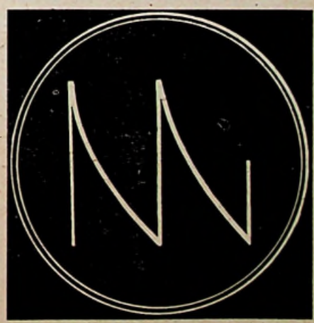
Fig. 4. De neon-oscillator levert ons een zaagtandgolfvorm volgens bovenstaande afbeelding.
